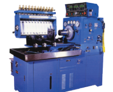
Máy cân chỉnh bơm cao áp DND-103W
