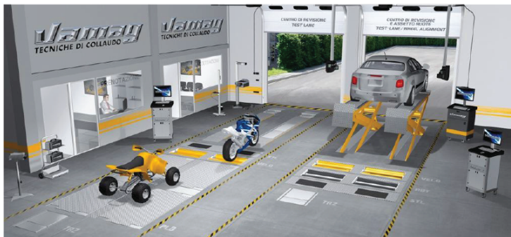
Thiết bị thử thẳng (phanh) VAMAG-(ITALY) RBT3500 XSW
