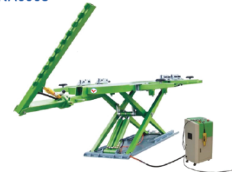
Thiết bị bị kéo nắn khung xe tai nạn KNS10703
