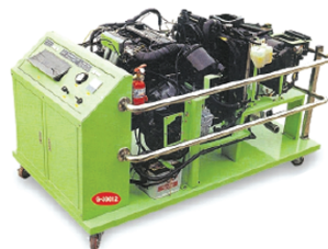
Động cơ phun xăng điện tử có hệ thống điều hòa
