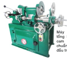
Máy mài trục cam có chuyên xe máy MCC16252
