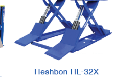
Heshbon HL-32X Cầu nâng cắt kéo 3.2 tấn
