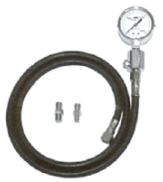
Kiểm tra áp suất nhớt CT-2 TOYO NPA Japan
