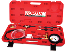
Kiểm tra áp suất bơm xăng JGAI0703 Toptul
